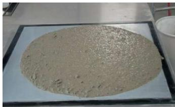
۱۲. پس از ساخت بتن و انجام آزمایش جریان اسلامپ در صورتی که حد مطلوب (حداقل cm ۶۰) به دست نیاید، اعضاء تیم یک مرتبه می‌توانند بدون کسر امتیاز و با اضافه کردن مصالح لازم، طرح خود را اصلاح نمایند. در صورت کم بودن جریان اسلامپ در دفعات بعد، آزمایش باید تکرار شود و ۵ امتیاز منفی برای هر آزمایش اضافه منظور خواهد شد. انجام سایر آزمایش‌ها لزوماً پس از رسیدن جریان اسلامپ بتن به حداقل مورد نیاز امکان‌پذیر است. آزمایش L و نمونه‌گیری می‌تواند همزمان انجام شود.
